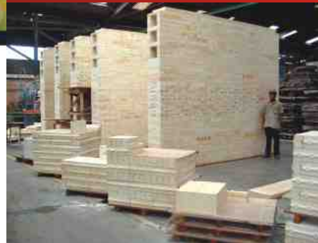
Peças para cozimento de anodo (fábrica de alumínio) Pieces for anode baking furnaces (aluminum plant)
