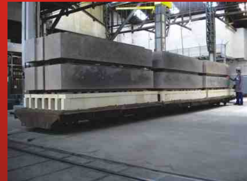
Peça especial utilizada em forno para produção de vidro plano Special piece used in float furnaces for the production of flat glass
